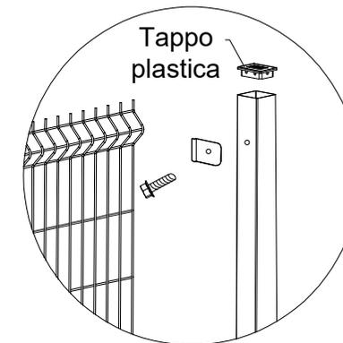
DETTAGLIO ASSEMBLAGGIO PANNELLO
